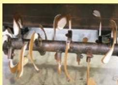
摩耗、破損があると土が起こ せなくなり、トラクターへの 負荷が強くなり、不慮の事故に繋 がる可能性。
